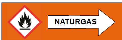
Bild 3 Exempel på märkning av gasledning.
